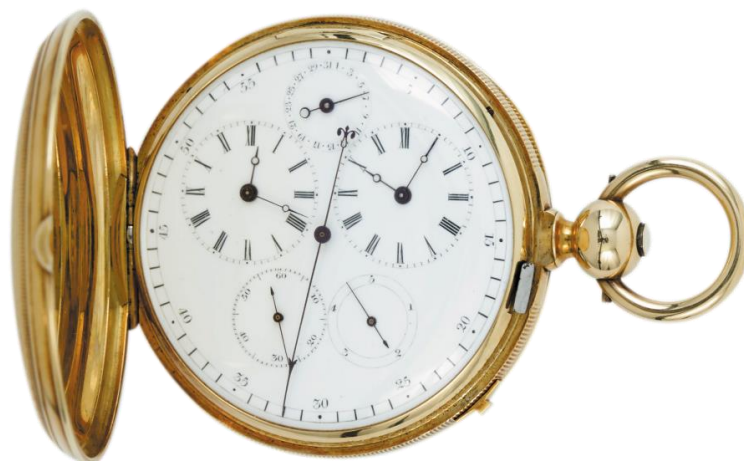
Montre de poche à double fuseau horaire et indication des \frac{1}{5}^e de seconde, Courvoisier Frères, La Chaux-de-Fonds, v. 1850 © MIH, V. Savanyu
